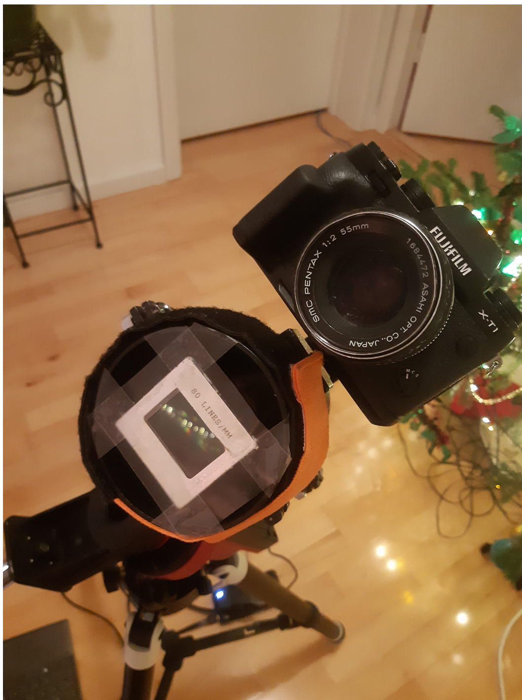
Det optiske gitter er monteret med 4 stykker tape foran på objektivet.
